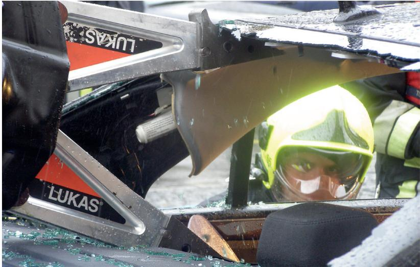
Abb. 65: Hybridgaszylinder
